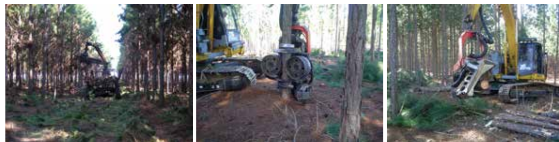
Sequência de fotos com diferentes etapas da colheita: corte, seccionamento e baldeio, em operação de Desbaste.
